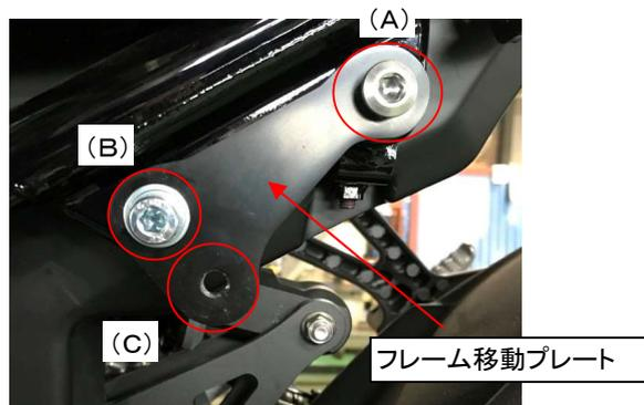
② タンデムステップフレーム移動プレートを装着します。
