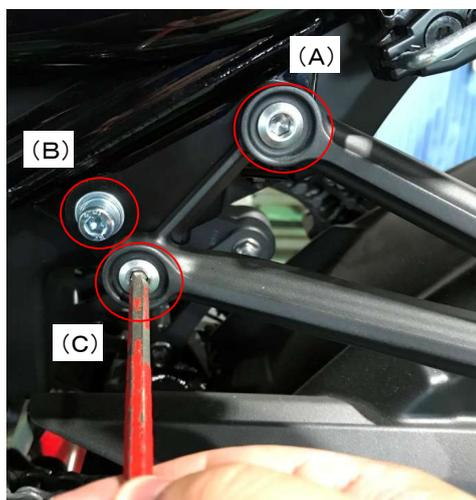
③ ①で取り外したタンデムステップフレームを装着します。
