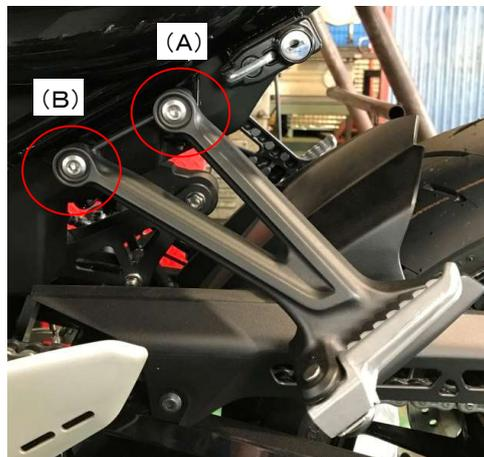
① M8六角レンチを使用してAとBのボルトをゆるめ、タンデムステップフレームを取り外します。
