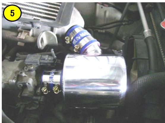
⑤ ターボホース、締め付けバンドを適正な位置に移動させ確実に締め付けを行う。
