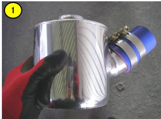
① インタークーラー側のターボホースをチャンパー本体へ、出来るだけ差し込み取付けておく。この時、締め付けバンド2ヶをホース側へ入れておく。
