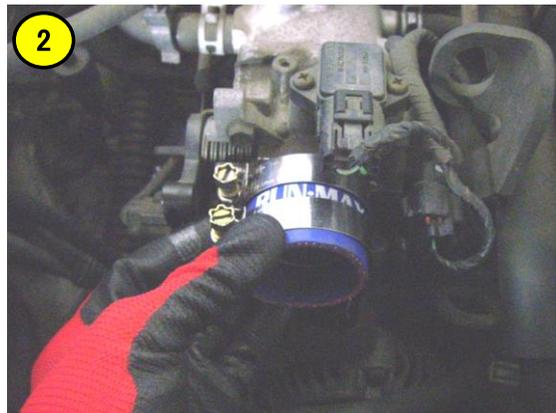
② スロットル側のターボホースを車体側へ取付けておく。この時、締め付けバンド2ヶをホース側へ入れておく。
