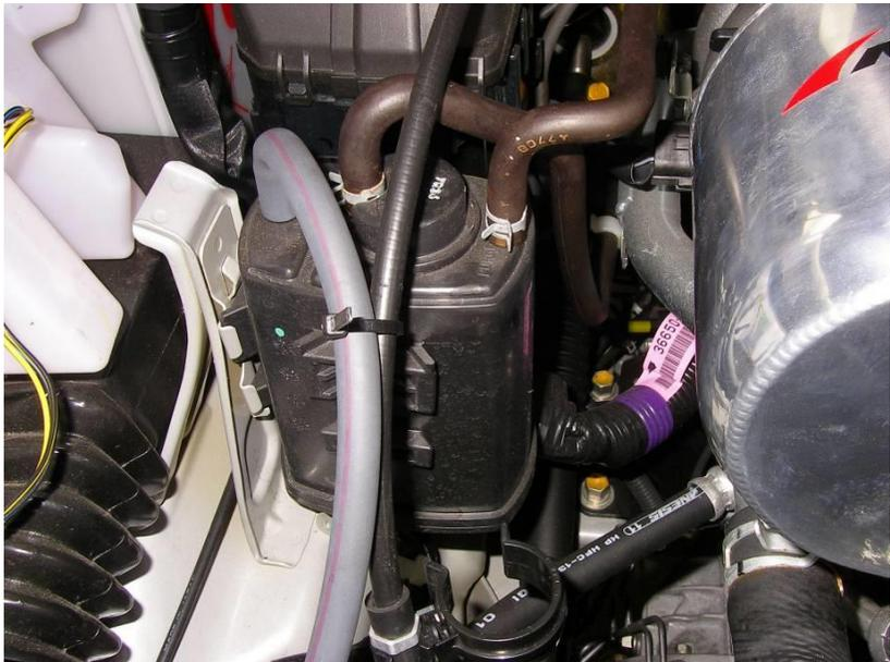
・クラッチワイヤについては、上下2箇所でクランプされていますが、上のクランプを外し、向かって左側に移動させ、タイラップ等で固定してください。
