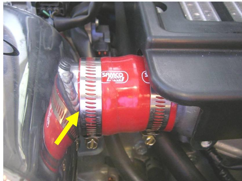
バンドの位置: ホース端面に寄せて取付ける事。※ビードロール(ホース抜け防止加工)との位置関係にてホースの裂けを防止する為です。
