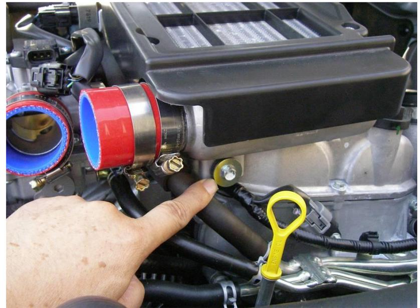
※インテークチャンバーを装着する際、上記写真の2点を緩めて、作業を行うことより、装着が容易になります。
