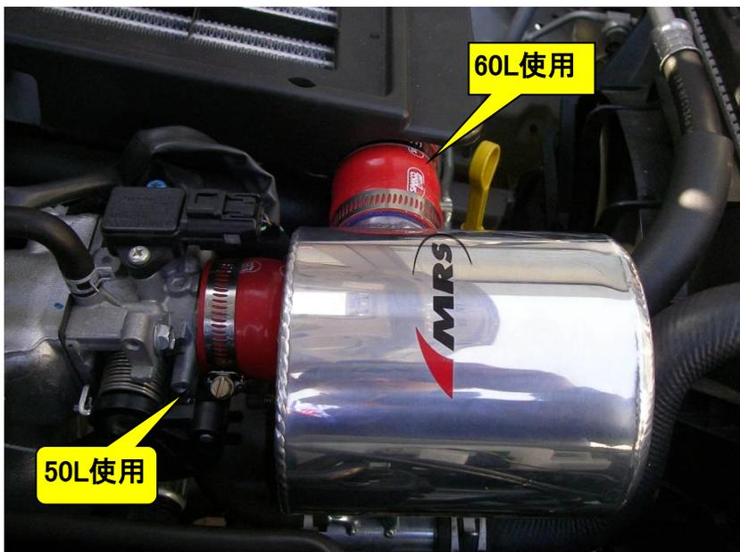
バンド4点は均等に締めていきチャンパー本体を水平に取付ける様ご注意下さい。ボンネットとのクリアランスを設ける様に取付ける事。
