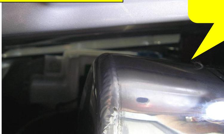
チャンパー本体を水平に取付け、ボンネットとのクリアランスが出来る様に取付けて下さい。
